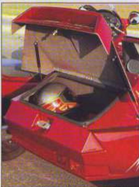
**Bagages** déverrouillé depuis la boîte à gants du side, le coffre s'ouvre automatiquement grâce à des vérins. Il offre une capacité appréciable de 330 litres.
