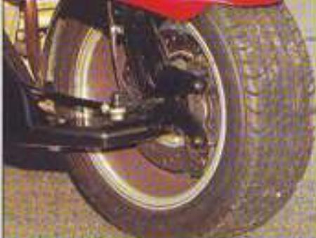
**Sécurité** l'étrier 6 pistons d'origine est conservé pour pincer un disque fonte. Le nouveau bras de suspension avant est réalisé en tubes et tôle d'acier.
